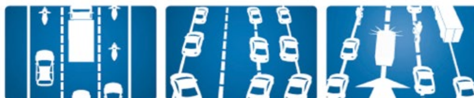
DIE RETTUNGSGASSE AUF MEHREREN SPUREN
